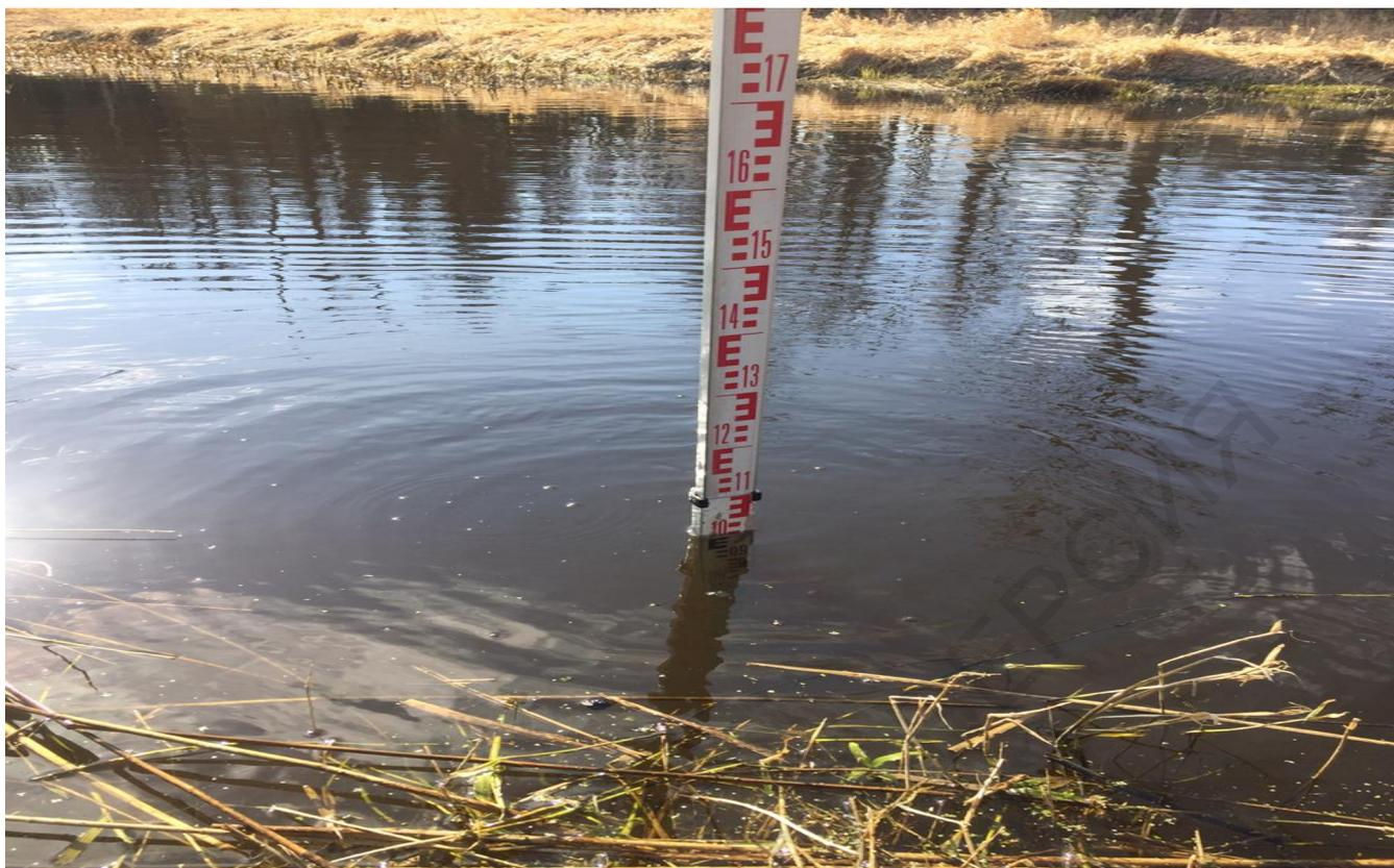
Рис. 4.2.1 Измерение уровня воды в реке
